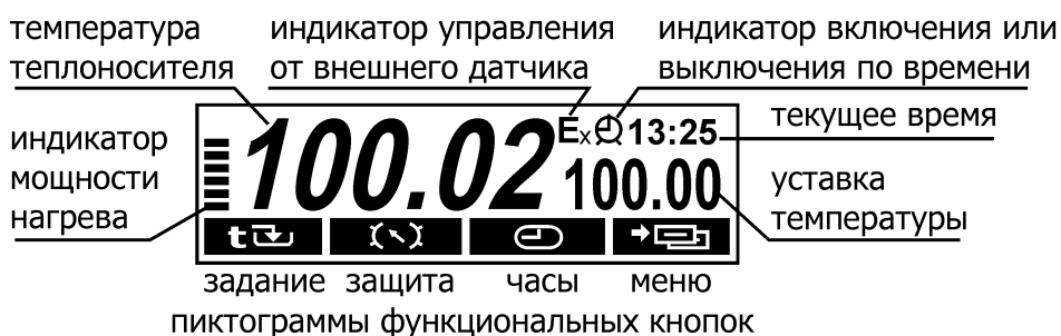
Рисунок 3 — Дисплей в режиме регулирования по уставке
