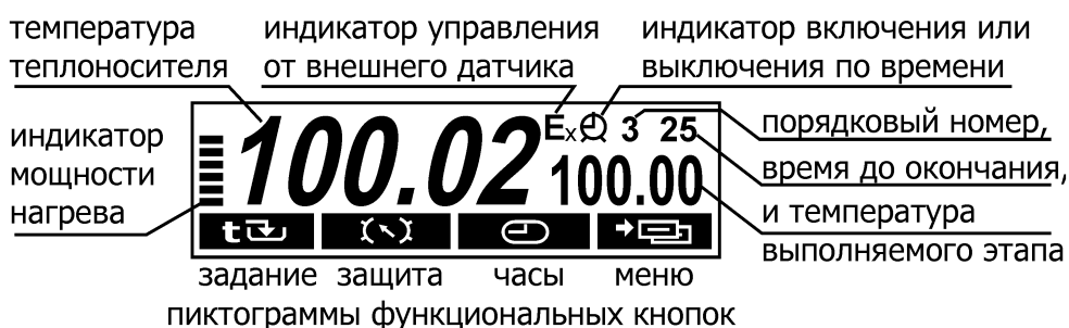
Рисунок 4 — Дисплей в режиме регулирования по программе
